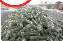
Création des préformes, désormais au sein même de l'usine
