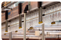
Souffreuse : transformation des préformes en bouteilles
