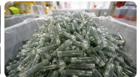
Préformes de PET recyclé avant soufflage en bouteilles
